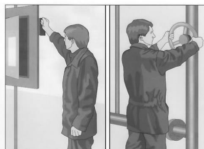
По команде руководителя остановить производство (оборудование) по схеме аварийного отключения. Отключить вентиляцию и электрооборудование. Перекрывать краны и задвижки на трубопроводах подачи газа, масла, агрессивных и горючих жидкостей. Открыть задвижки для их слива в аварийные ёмкости
